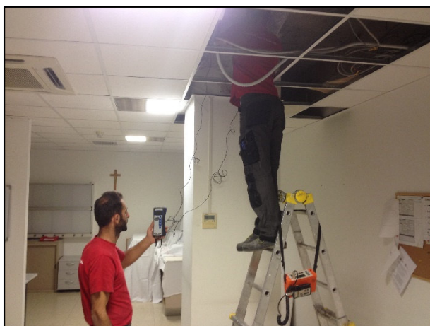
Alcune fasi delle misure ultrasoniche e sclerometriche.
