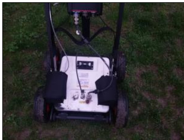
Sistema di gestione Georadar Hi Mod della IDS.
