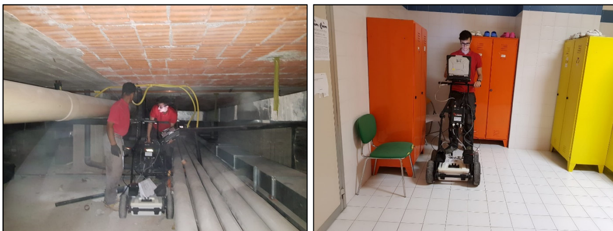
Alcune fasi delle indagini georadar (impalcato 0 e -1).
