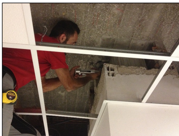
Alcune fasi delle misure ultrasoniche e sclerometriche.
