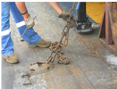
*(La catena è messa in tensione avvitando il tornichetto con una leva)*
