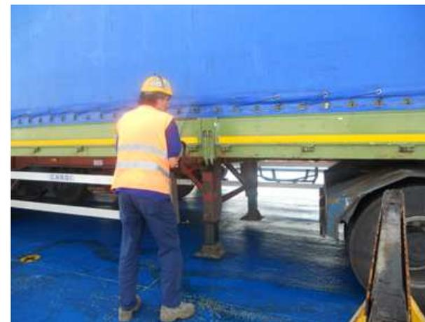
***(Abbassamento delle zampe di stazione del SMR)***
