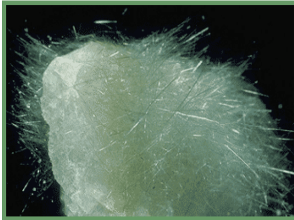
AMIANTO O ASBESTO
