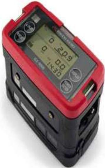
Sono dispositivi che al loro interno hanno tutti i componenti dei sistemi fissi: sensori, elettronica di controllo e sistema di campionamento, oltre all'alimentazione a batteria.
