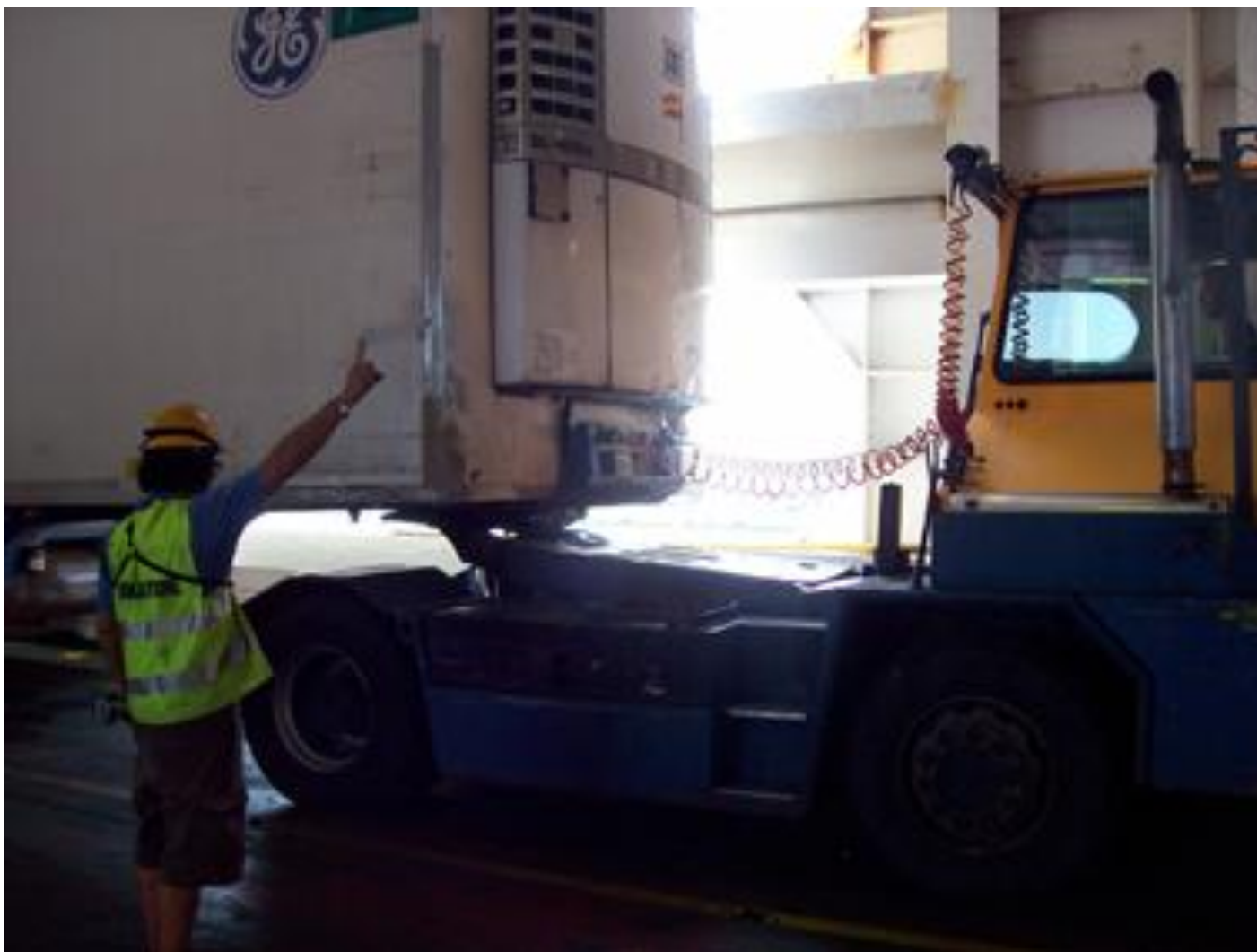
(Il SMR è sollevato dalla ralla)
