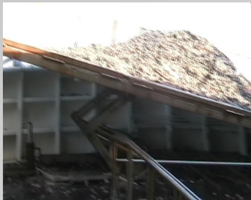
a) Piano di scarico del pescato elevabile e inclinabile
