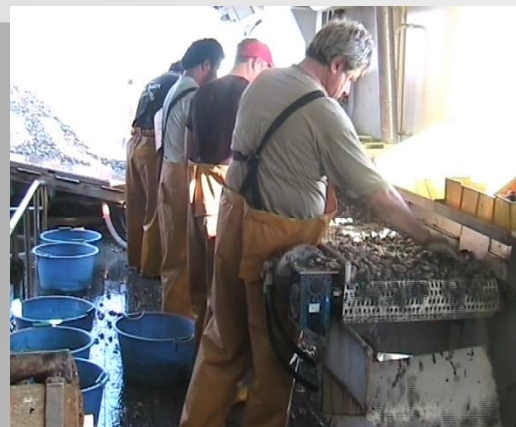
b) Spinta del pescato verso destra con acqua e suo prelavaggio
