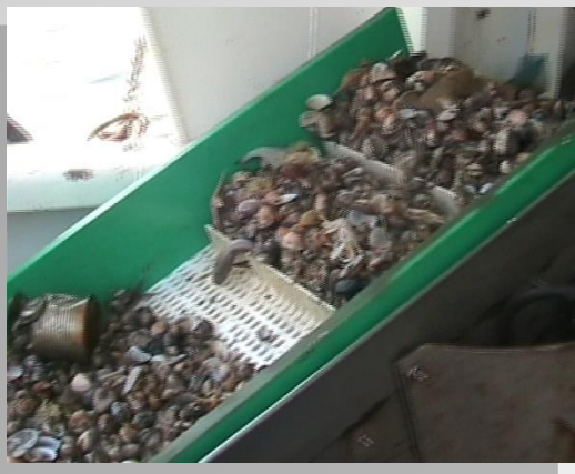
a) Piano di scarico del pescato elevabile e inclinabile
