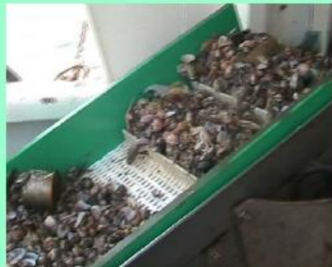
Nastro di carico e lavaggio
