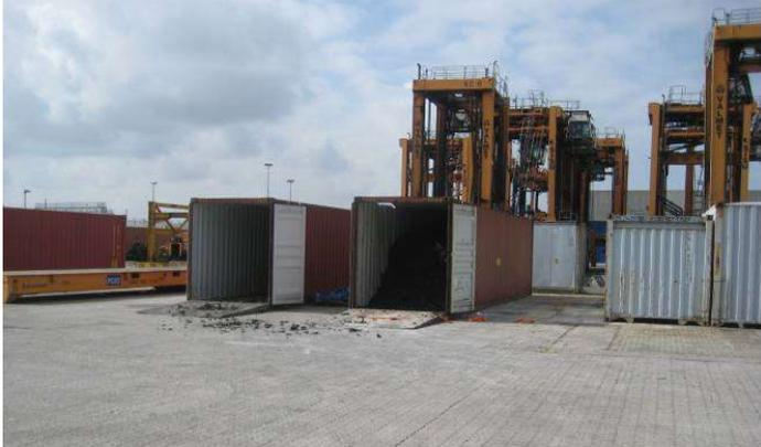
Un'operazione di svuotamento e riempimento di un contenitore danneggiato di merce pulvirulenta, con mezzo meccanico le cui dimensioni occupano l'intero contenitore. Più ci si introduce nel contenitore, più l'ambiente assume la configurazione di «luogo confinato» con esposizione a polveri asfissianti. Molto difficile è il recupero in emergenza in caso di malore del lavoratore alla guida del mezzo.
